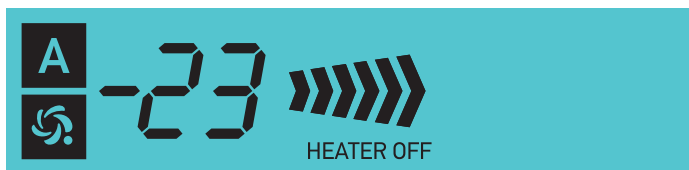
Рисунок 5.7 — Вид ЖК-дисплея, когда прибор соединен с базовой станцией системы MagicAir и находится под ее автоматическим управлением, нагреватель выключен или отсутствует в комплектации
